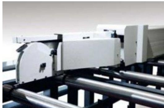
Высокоточная цилиндрическая зубчатая рейка, смонтированная на жесткой конструкции, обеспечивающая точные перемещения и оптимальное направление (управление траекторией движения) подающего захватывающего устройства.
